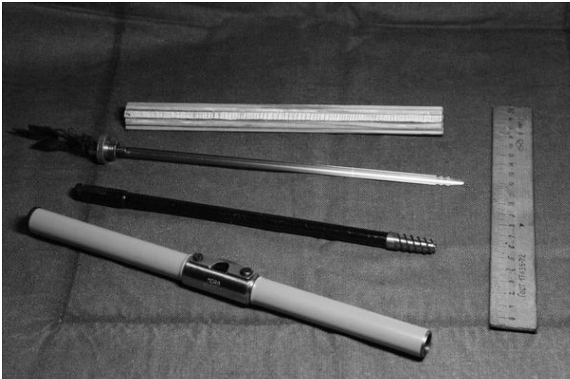
Рис. 1. Возрастной бур «Haglof» с экстрактором
