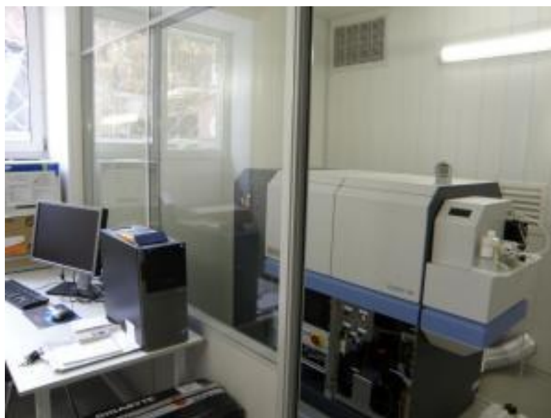
Рис. 2. Масс–спектрометр высокого разрешения с ионизацией в индуктивно–связанной плазме для рутинного элементного и изотопного анализа ELEMENT–XR (фото с сайта
